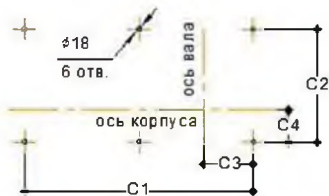
Схема расположения отверстий под фундаментные болты
