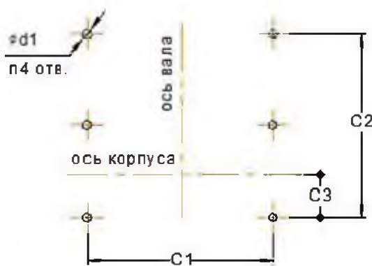
Схема расположения отверстий под фундаментные болты
