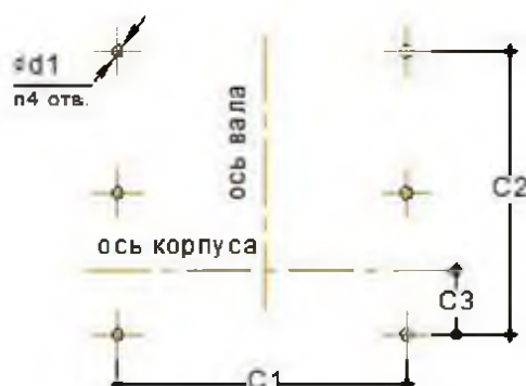
Схема расположения отверстий под фундаментные болты
