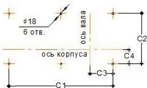
Схема расположения отверстий под фундаментные болты
